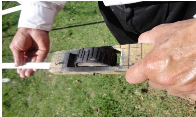
Fig. 6: Con el rodillo se dibuja la tela, el cual va a marcar la labor del rebozo.
